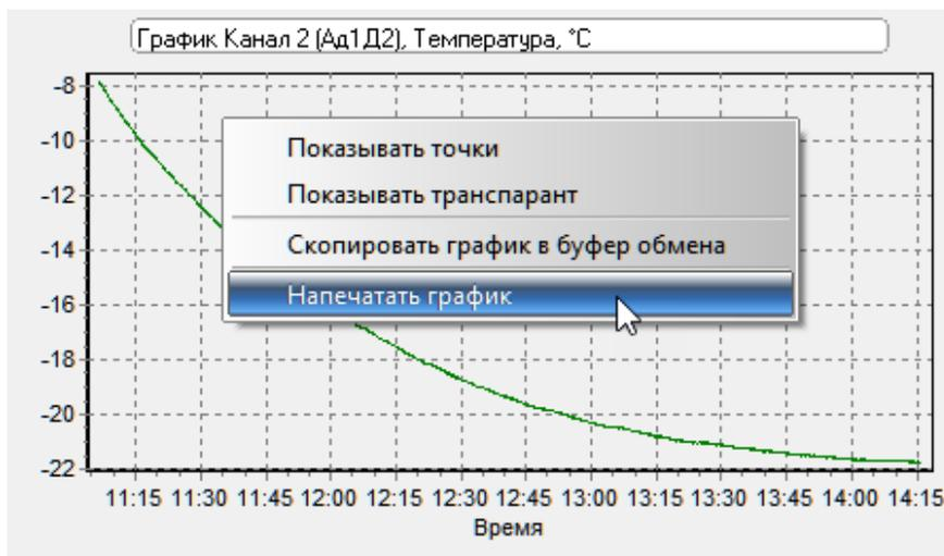
При этом появляется окно предварительного просмотра, в котором можно выбрать используемый принтер, задать его параметры, ориентацию и место расположения графика на бумаге, размеры графика
