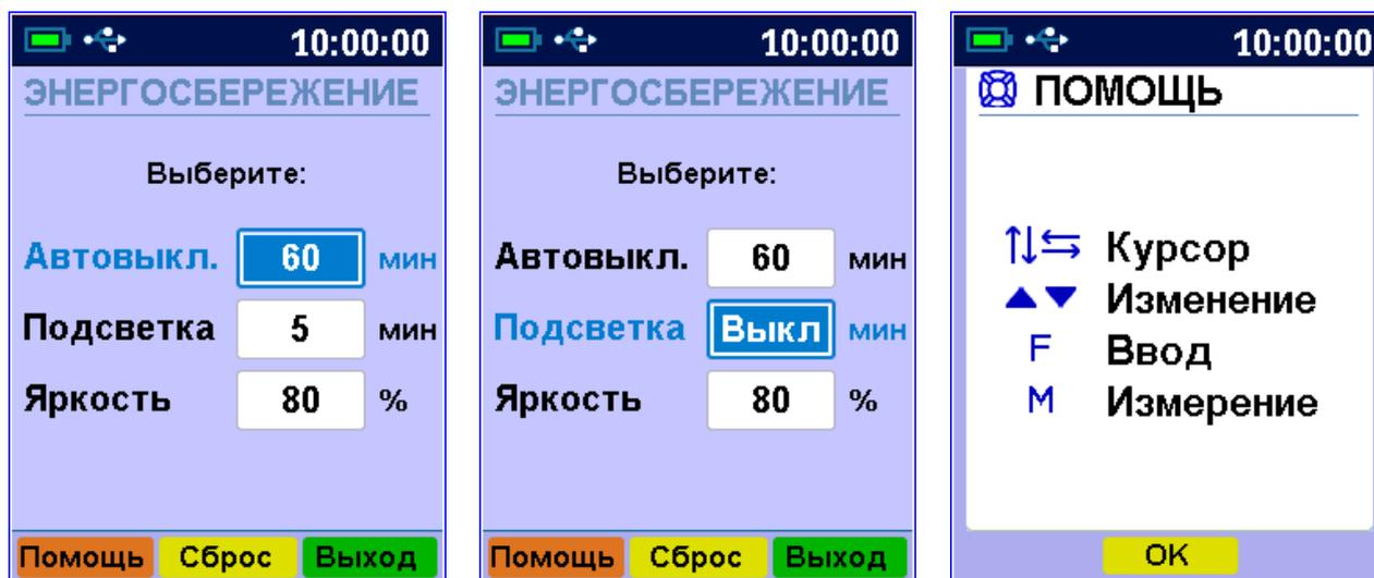
Кнопками **▲**, **▼** выбирается значение интервала времени или яркости дисплея, кнопками **↑**, **↓** выбирается изменяемый параметр. При увеличении времени до
