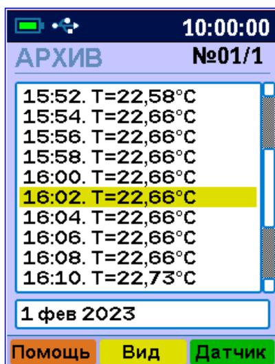
При нажатии на кнопку **Вид** можно изменить вид отображения на экране дисплея результатов измерений (подробнее в п.5.7).
