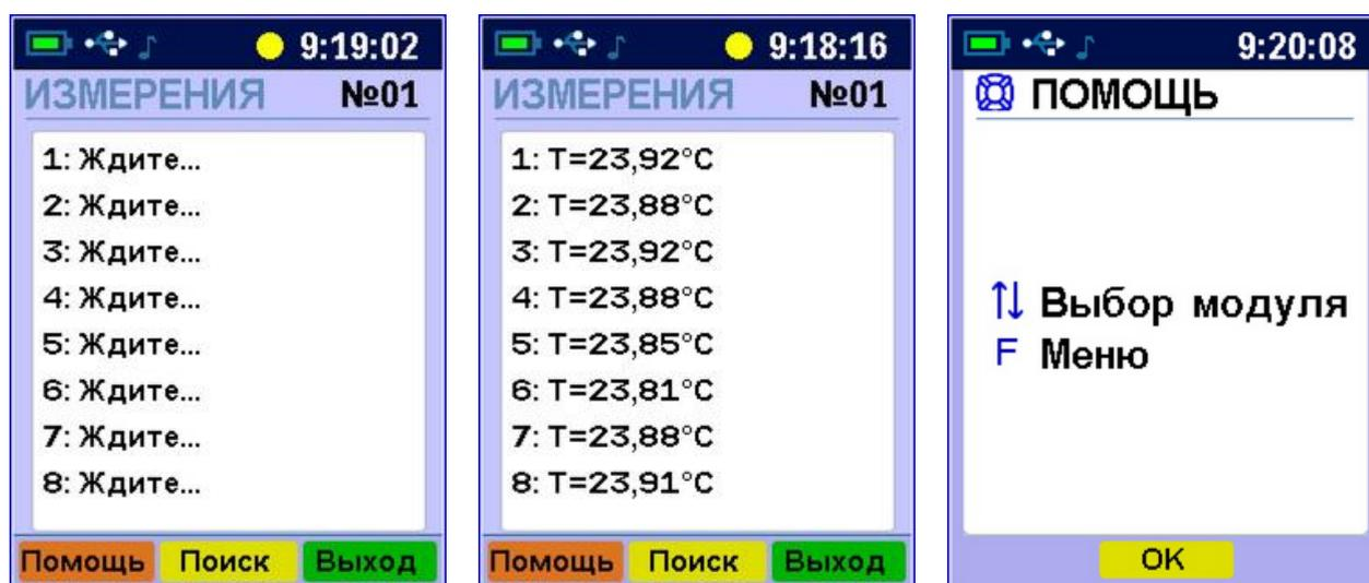
Здесь в каждой строке представлены результаты измерений датчиков, подключенных к тому или иному модулю. Вверху справа выводится номер подключенного модуля.
