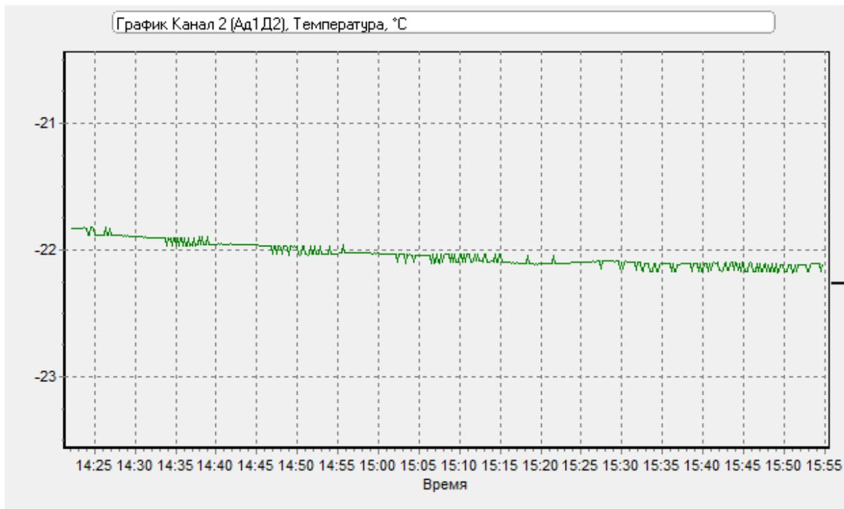
Если установлен флажок «Авто», в качестве минимального диапазона используются значения, выбранные для соответствующих типов датчиков разработчиком программы. На рисунке в примере ниже значения ограничены значениями минус 21 °С и минус 22 °С.
