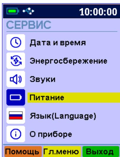
При разряде до близкого к критическому значению 3,6 В, прибор начинает работать в режиме экономии электроэнергии – устанавливается минимальная яркость подсветки дисплея. При критическом разряде аккумулятора (3,3 В) появляется сообщение «Зарядите АКБ», подается характерный звуковой сигнал, и прибор автоматически выключается.
