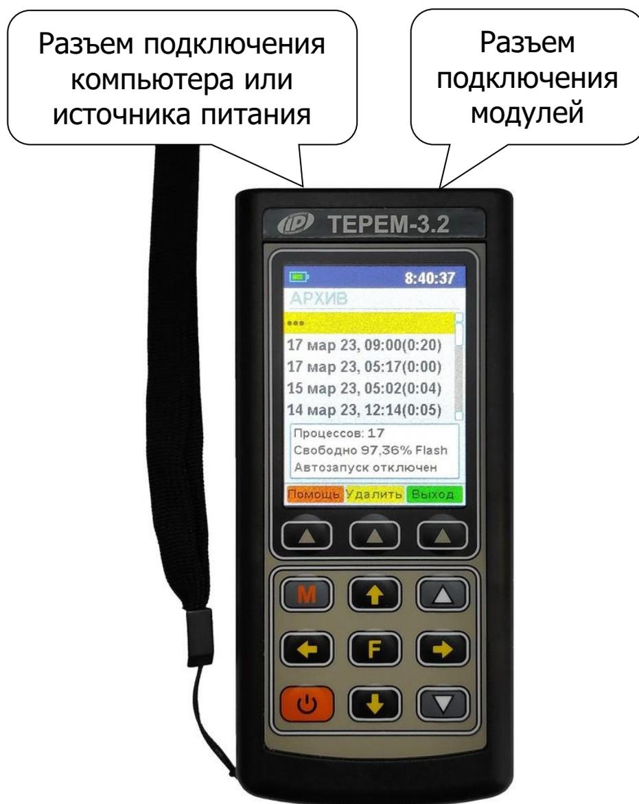
Рисунок 3 - Внешний вид центрального устройства
