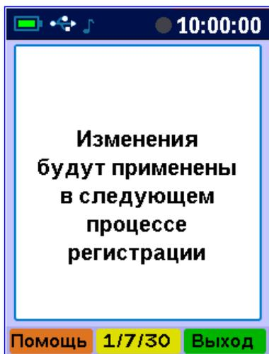
При выходе по кнопке **F** в зависимости от выбранных параметров появится сообщение «Автозапуск отключен» или время следующего старта или окно с соответствующим предупреждением.
