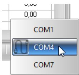
При обнаружении прибора, подключенного к выбранному COM-порту, номер COM-порта запоминается в настройках программы и используется в дальнейшем автоматически.
