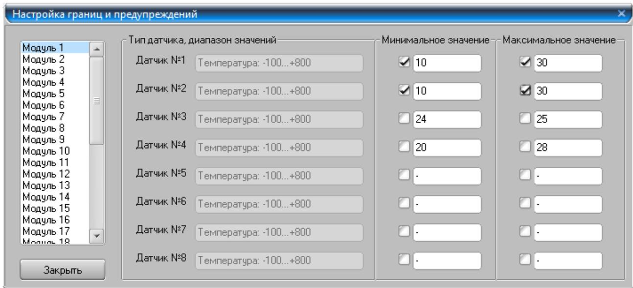
После установки пороговых значений можно проверить любой считанный процесс регистрации на предмет превышения этих значений. Для этого выбирается любой из процессов в списке считанных из прибора процессов,
